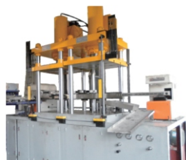
冲压机械手抓取移栽
