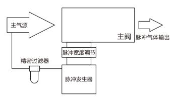
相比较连续气流吹扫,间断式气流吹扫反复吹喷工件,提高吹扫效率。
